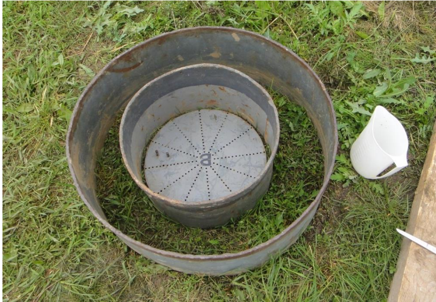
Obrázek 3.4 Douvalcový infiltrometr, zdroj: Bátková a kol. (2013).
