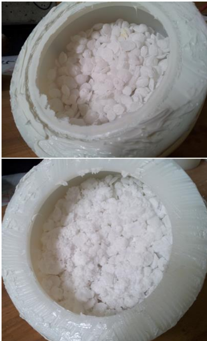
Obrázek 25: Srovnání míry reakce KOH na K_2CO_3 ; nahoře Nanofil-2, dole chybný Nanofil-3.
