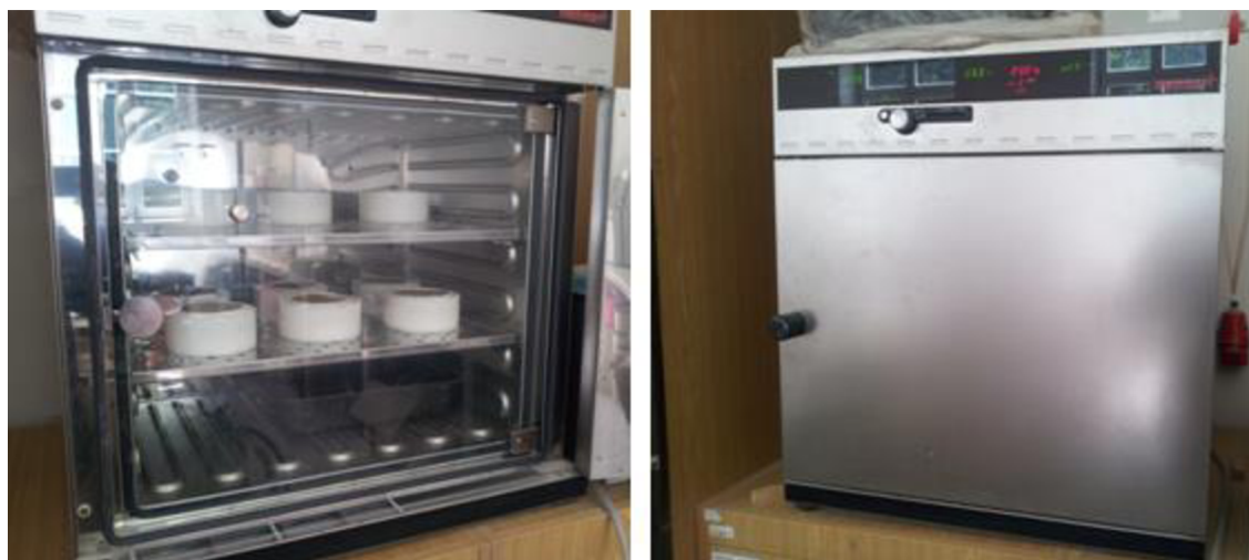
Obrázek 24: CO 2 -inkubátor Memmert INC 108.
