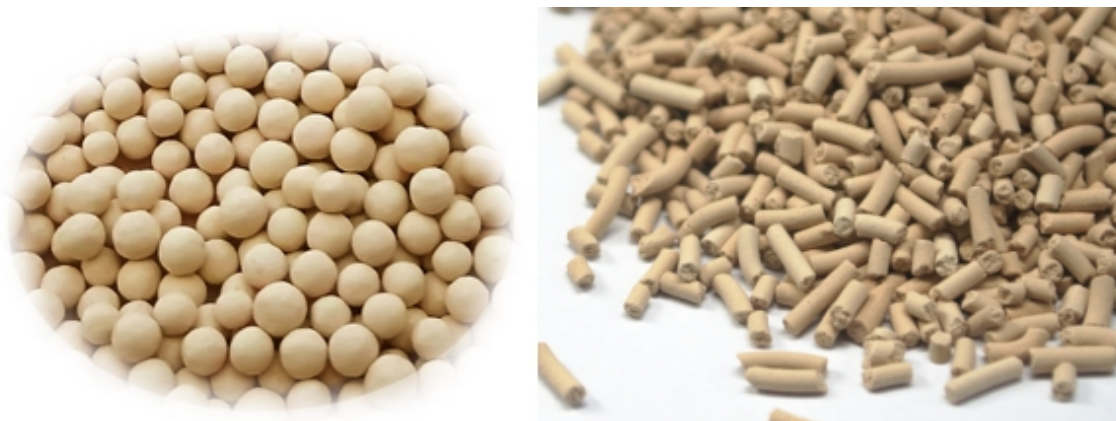
Obrázek 18: Zeolit ve formě kuliček a peletek
