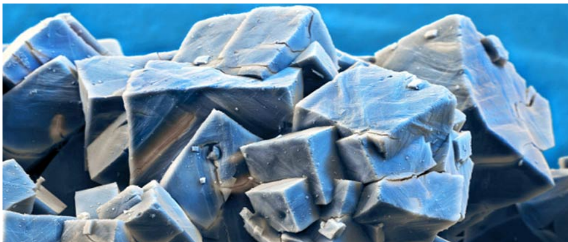
Obrázek 20: Snímek adsorbentu MOF z mikroskopu [53]
