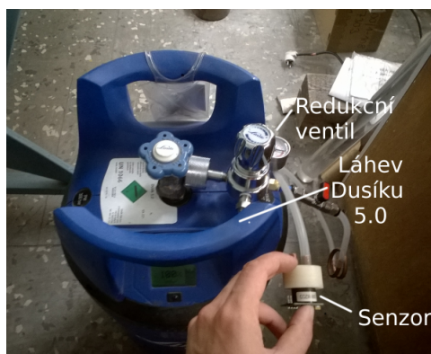
Obrázek 31: Ukázka z kalibrace senzoru.
