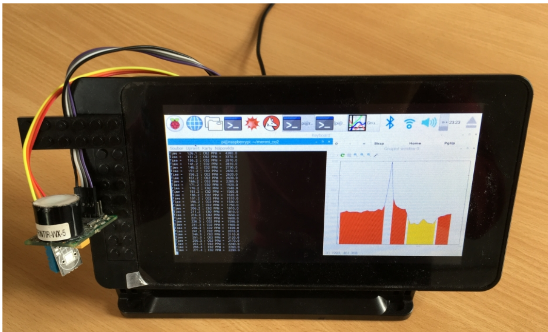
Obrázek 2: Raspberry Pi v úpravě pro měření CO 2 v místnosti.
