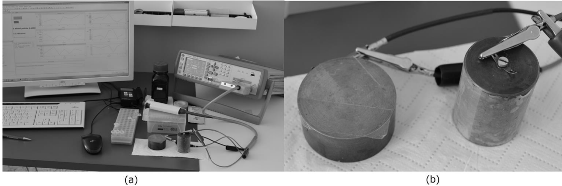
Obr. 5.2 Reálné zapojení měřicího pracoviště pro dielektrickou spektroskopii (a) a detail systému elektrod pro vložení vzorku (b).
