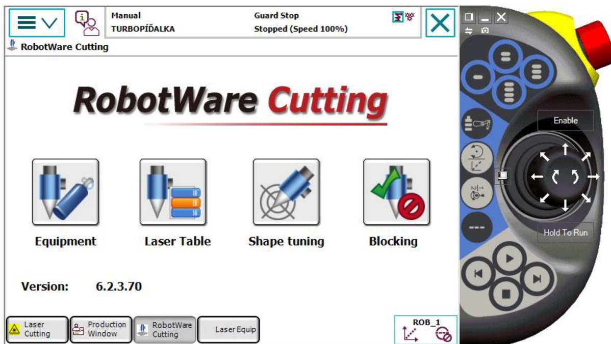
Obr. 42) Uživatelské rozhraní – RobotWare Cutting
