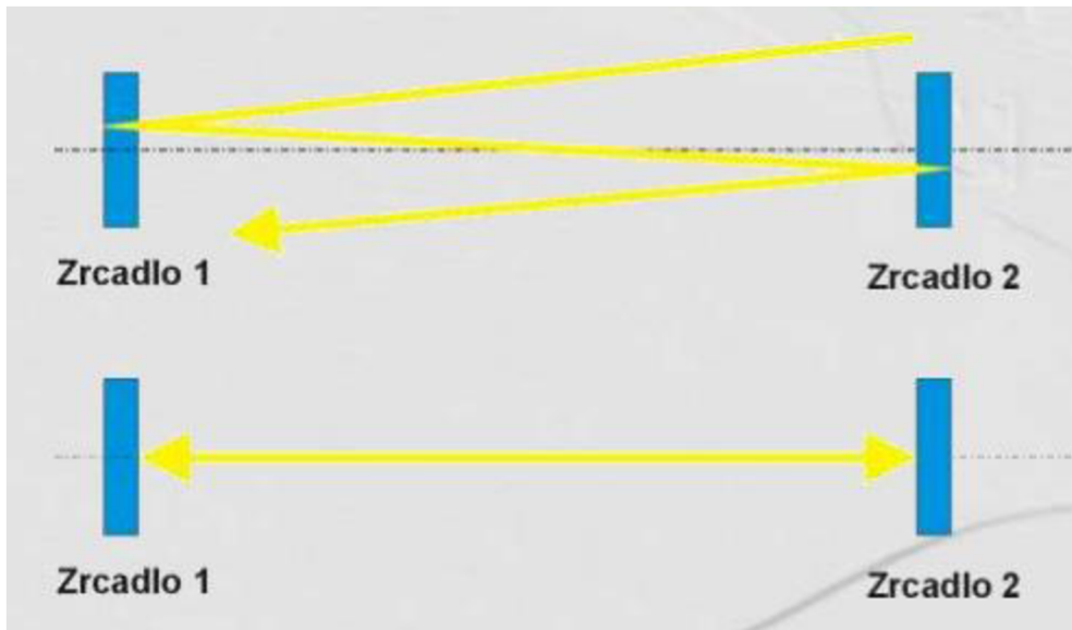
Obr. 6) Pohyb fotonů v optickém rezonátoru [15]
