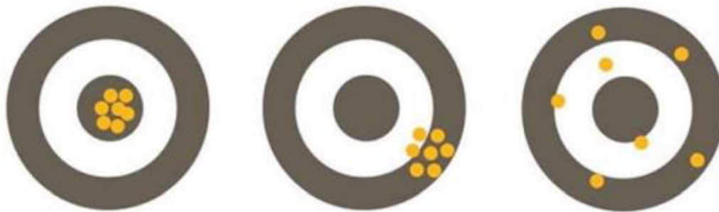
Obr. 16) Zobrazení pojmů přesnost a opakovatelnost (vlevo – dobrá přesnost i opakovatelnost, uprostřed – dobrá opakovatelnost a špatná přesnost, vpravo – špatná opakovatelnost a dobrá přesnost) [33]
