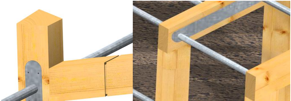
Obrázek 29: Designové prvky s funkcí konstrukční ochrany.
