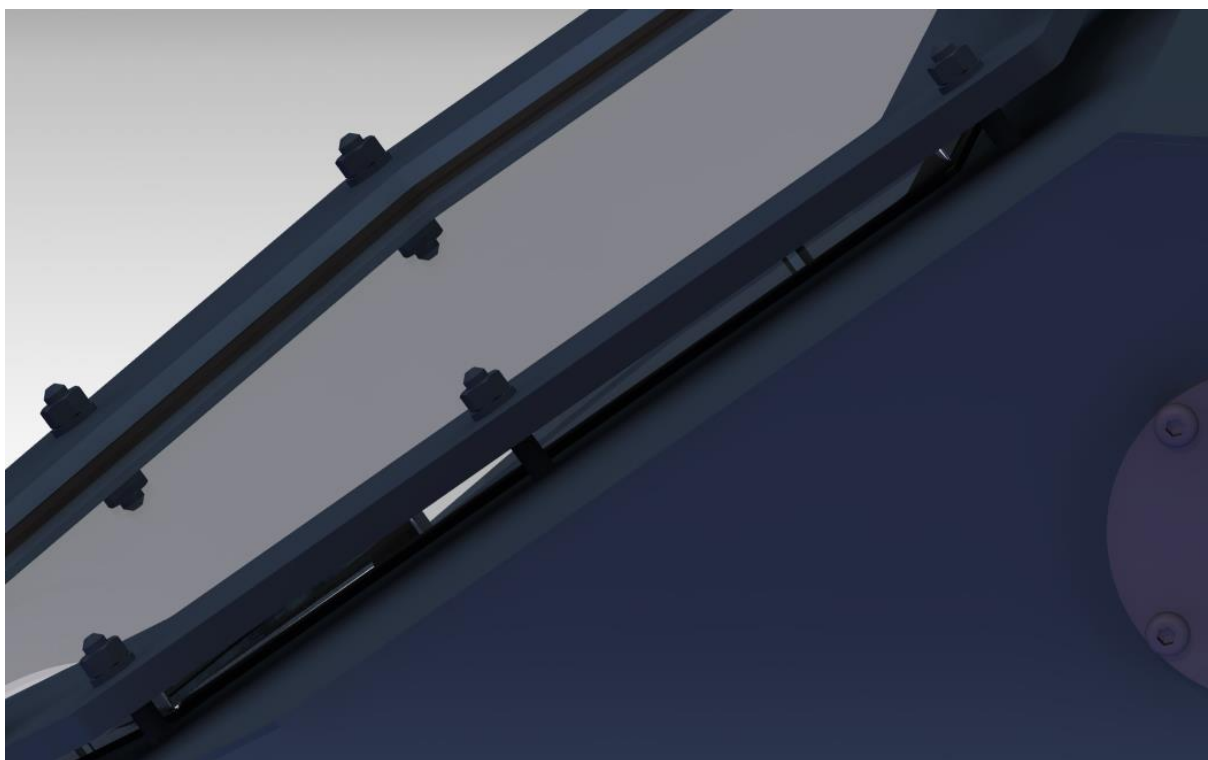
Obr. 5.15: Detail těsnění plexiskla průzoru svařovací komory /40/
