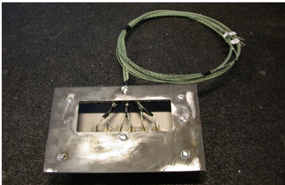
Obr. 5.5: Reálné připojení termočlánků, včetně zalití vysokoteplotní pastou /27/
