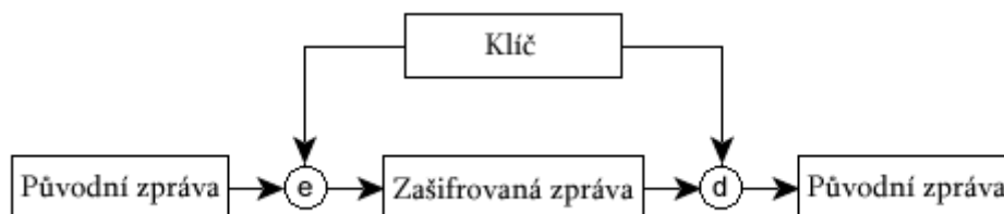
Obrázek 2.6: Proces symetrického šifrování a dešifrování
