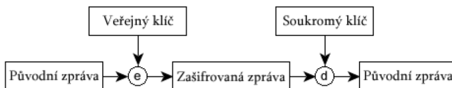
Obrázek 2.7: Proces asymetrického šifrování a dešifrování
