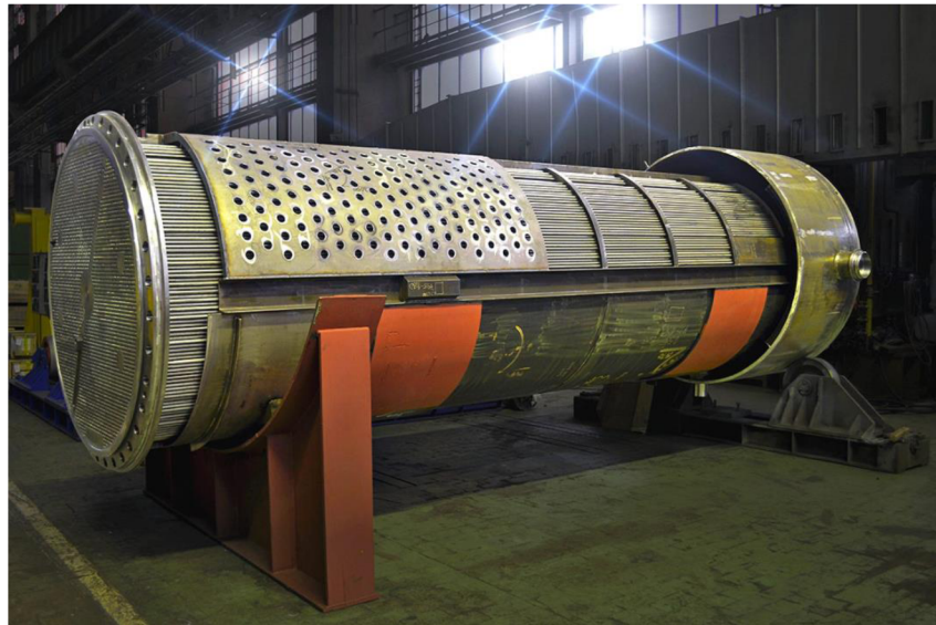
Obr. 4.4 Trubkový svazek NTO [23]
