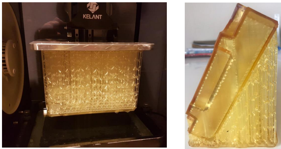
Obr. 91 Tisk tvárníku metodou DLP.
