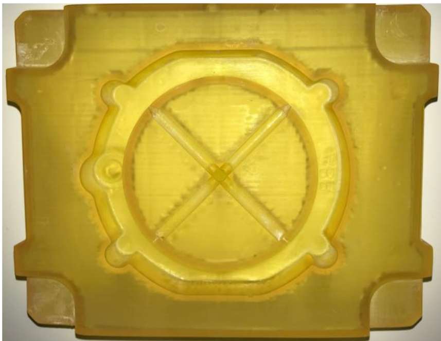
Obr. 93 Tvárnice vyrobenou metodou DLP.
