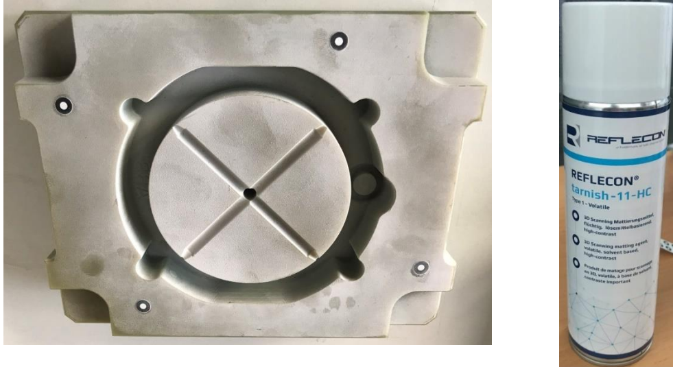
Obr. 63 Tvárnice s body + samovypařovací sprej.
