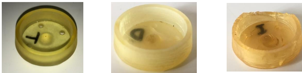
Obr. 100 Testovací misky – po teplotní zkoušce.
