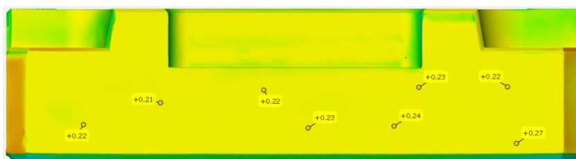
Obr. 80 Kontrola šířky tvárnice – varianta 2.
