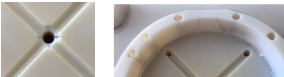
Obr. 107 Tvarové vložky – praskliny vlivem vstřikovacího cyklu.
