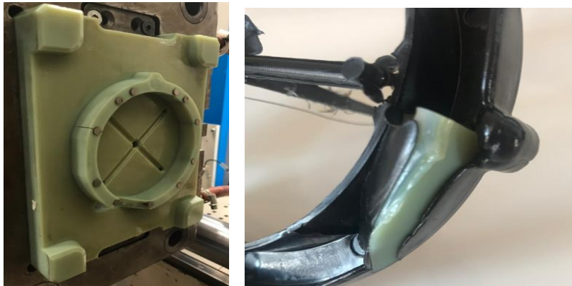
Obr. 110 Zničený tvárník – varianta 2.
