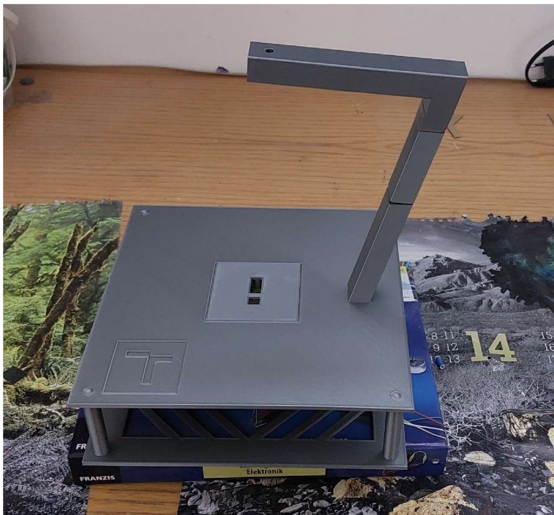
Obrázek 13 - celková konstrukce držáku elektromagnetu
