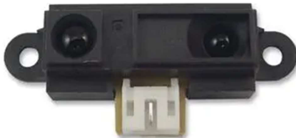
Obrázek 14 - zvolený senzor GP2Y0A21YK
