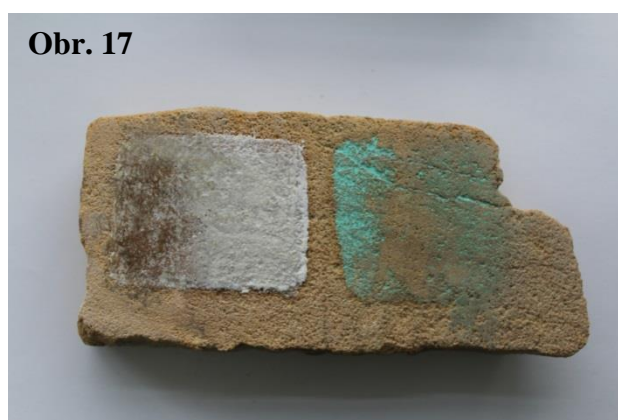
Obr. 15, 16, 17: Barevné nátěry po jejich mechanickém a chemickém odstranění
