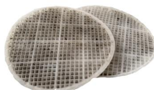
Obr. 15: Plastové nosiče biomasy využívané na ČOV Tlučná (vlastní foto)
