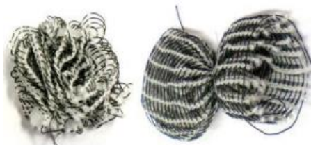
Obr. 14: Příklad nanovláknového nosiče biomasy (Borghei a Hosseini, 2004)
