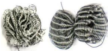
Obr. 14: Příklad nanovláknového nosiče biomasy (Borghei a Hosseini, 2004)
