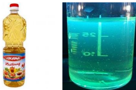
Obrázek 13: Luminiscence rostlinného oleje vybuzená UV lampou.
