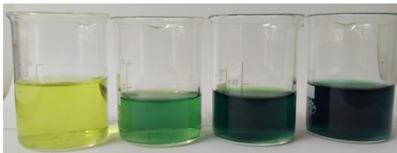
Obrázek 33: Barvy roztoků železitooxalátového komplexu po přidání hexakynoželezitého roztoku. Zleva – roztok neozářen, roztok ozářený 30 s, roztok ozářen 60 s a roztok ozářen 120 s.
