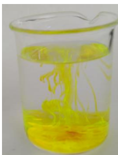
Obrázek 9: Difuze fluoresceinu ve vodě se dvěma peckami hydroxidu sodného.
