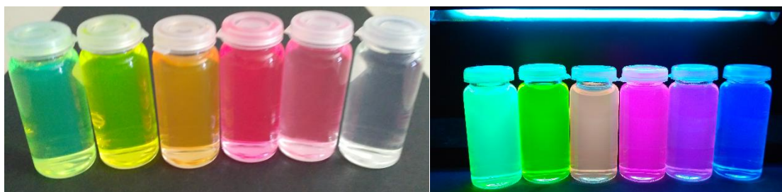
Obrázek 11: Barevné ethanolické roztoky vytvořené z náplní svítících tyčinek na denním světle a barevné ethanolické roztoky vytvořené z náplní svítících tyčinek pod UV lampou.
