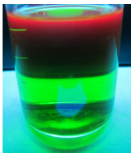
Obrázek 18: Luminiscence ethanolického extraktu špenátu vybuzená UV lampou.
