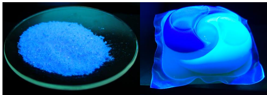
Obrázek 26: Luminiscence pracího prášku a kapslí Ariel vybuzená UV lampou.
