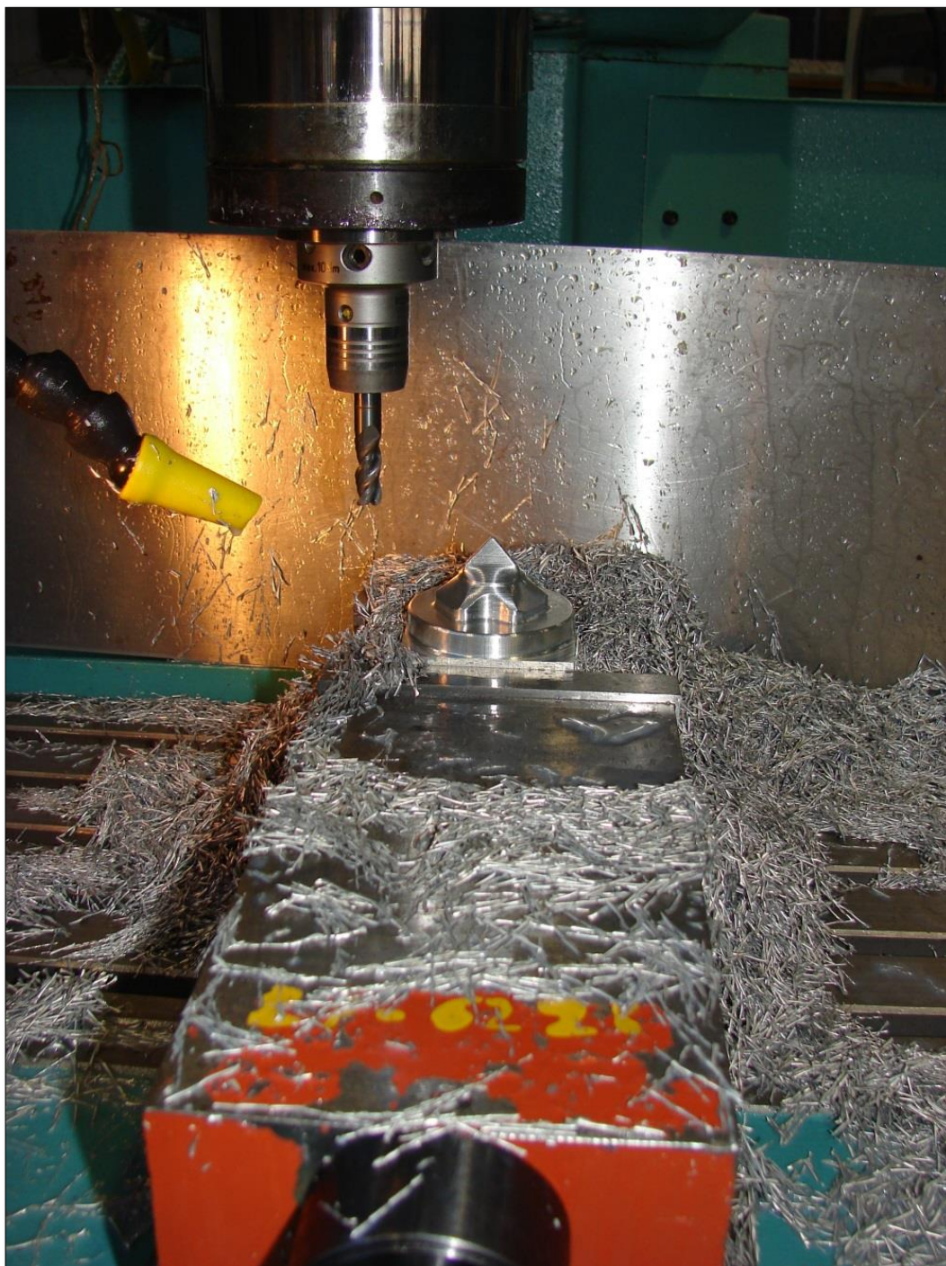
Obr 2.13 Vyhrubovaný vzorek metodou HPC na stoji FV 25 CNC A.
