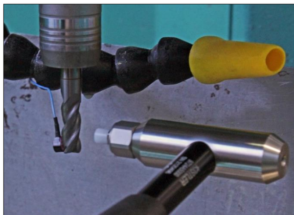
Obr. 1.12 Záznam jednotlivých kmitů při použití rázového kladiva.
