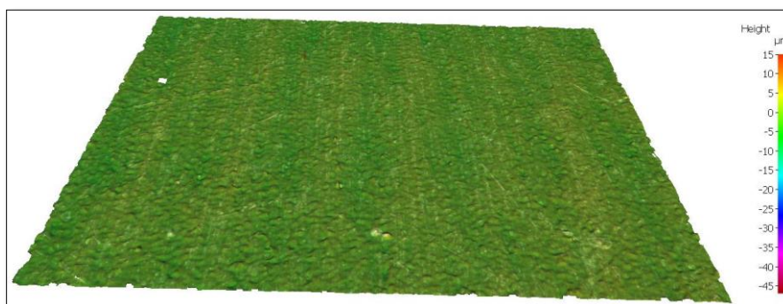
Obr. 3.8 Zobrazení nerovnosti a textury měřené plochy č. 1.
