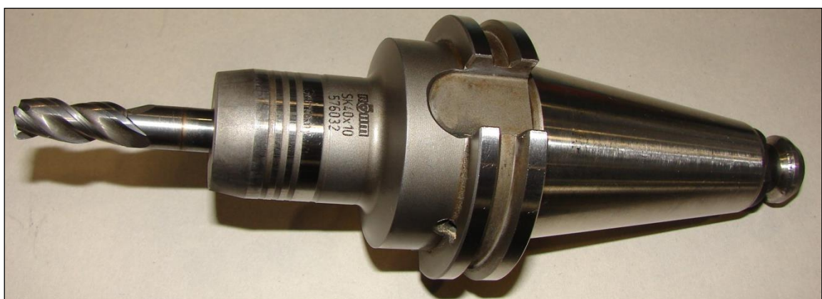
Obr. 1.6 Upnutí frézy č. 1.
