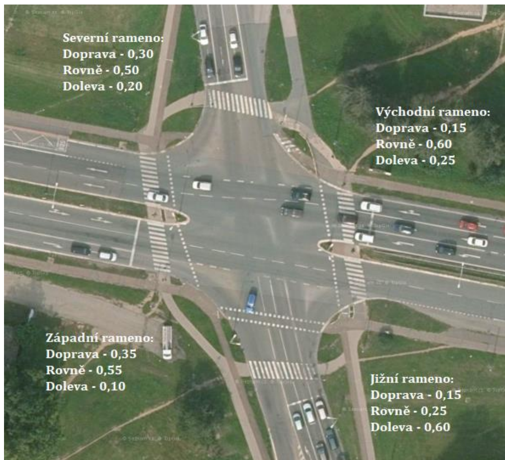
Obrázek 11: Křižovatka Mileta - pravděpodobnosti rozhodování (zdroj: mapy.cz, hodnoty vlastní)
