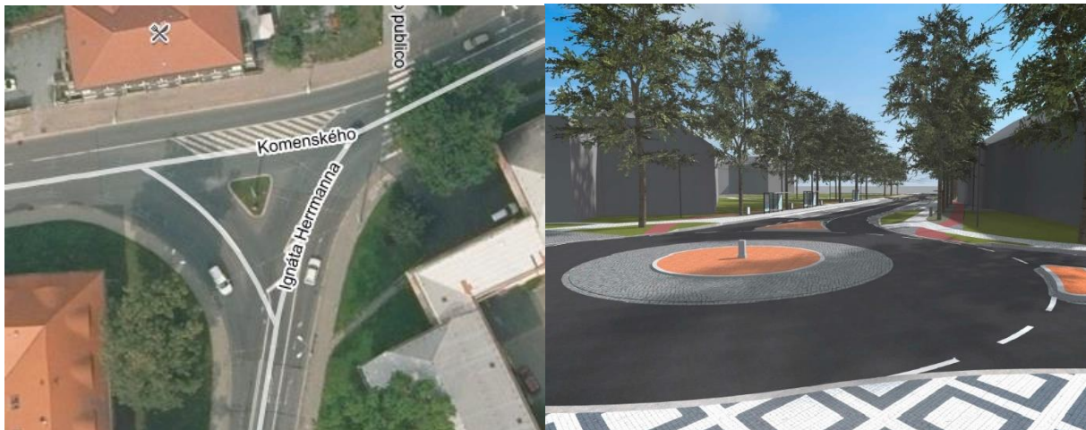
Obrázek 8: Stávající stav křižovatky Fortna (vlevo), Návrh kruhové křižovatky (vpravo) (Zdroje: mapy.cz; hkcity.cz)
