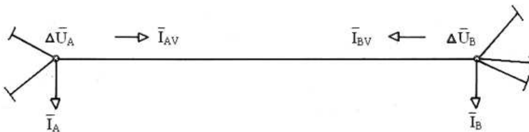
Obr. 4-3 Zmenšení počtu odběrů na vedení – situace po redukci odběrů
