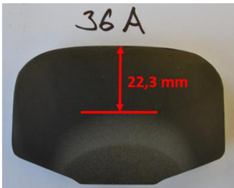
Obr. 55: Makrovýbrus vzorku 36A se zakótovanou hloubkou tepelně zpracované vrstvy určenou pohledem.
