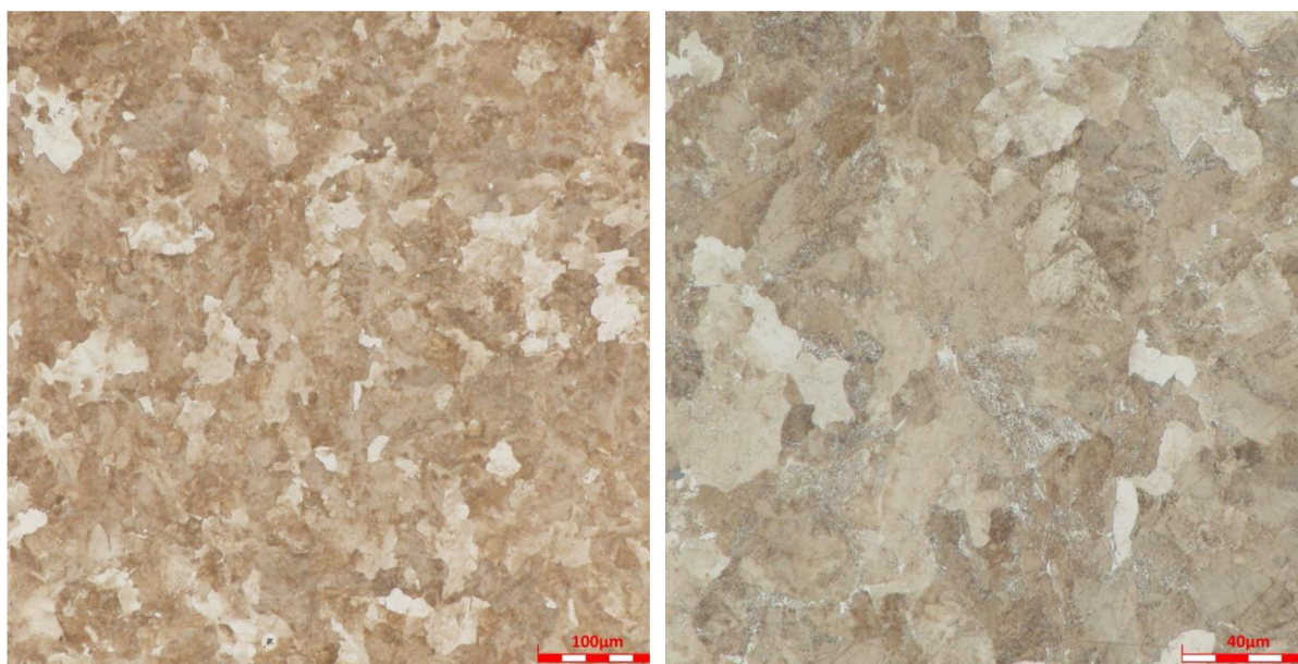
Obr. 41: Mikrostruktura vzorku 34A v hloubce 16 mm pod povrchem, vlevo zv. 100x, vpravo zv. 500x.
