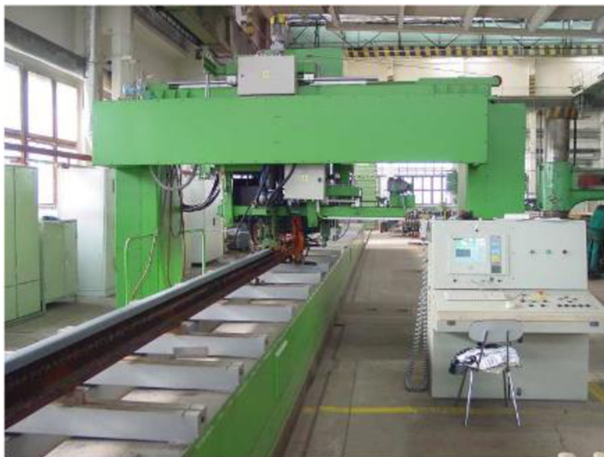
Obr. 25: Portálový stroj HPS-01 použitý pro tepelné zpracování. [24]
