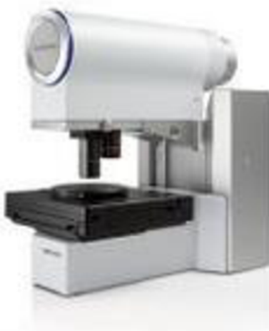
Obr. 16: Světelný mikroskop Olympus DSX510 použit v této práci. [21]
