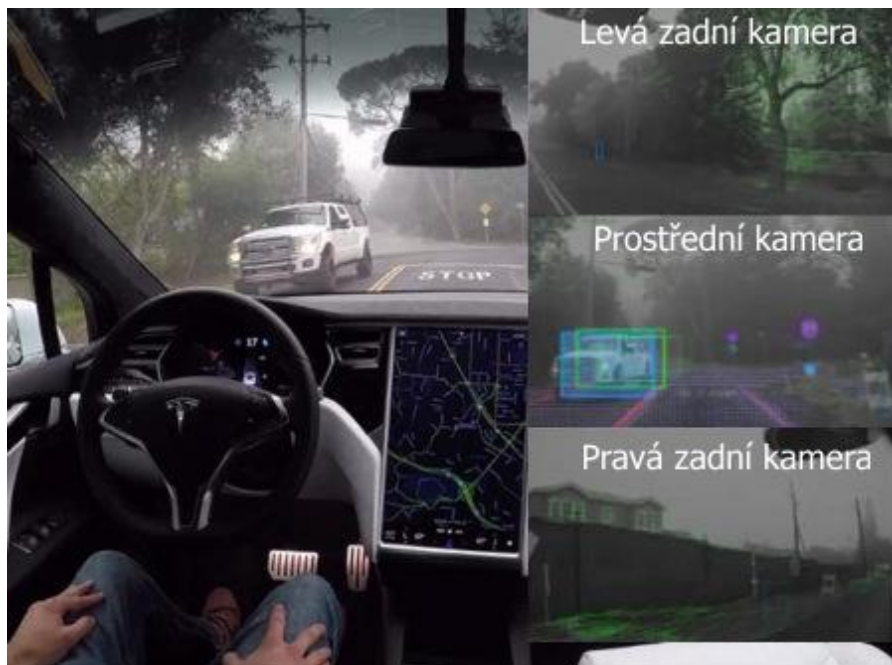
Obrázek 24 - Tesla model S - pohled „očima vozidla“ identifikace jednotlivých objektů
