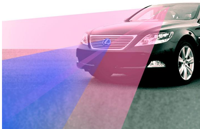
Obrázek 20 - Lexus LS 600h se systémem PCS, radar (modrá barva) a kamera (červená barva)
