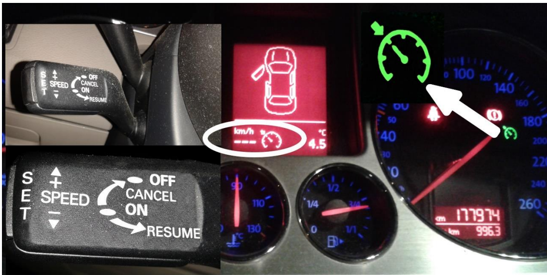
Obrázek 4 - Kontrolka a páčka tempomatu (VW Passat)
