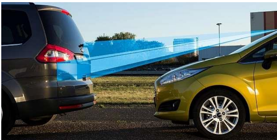
Obrázek 5 – Snímaná oblast kamerou - Active city stop (Ford)
