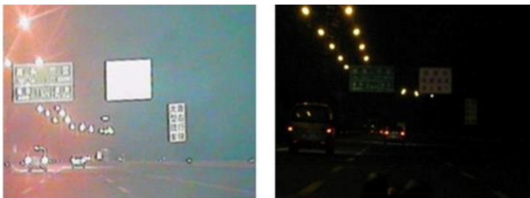
Obrázek 18 - Vlevo Snímek pořízený termokamerou a vpravo normální kamerou
