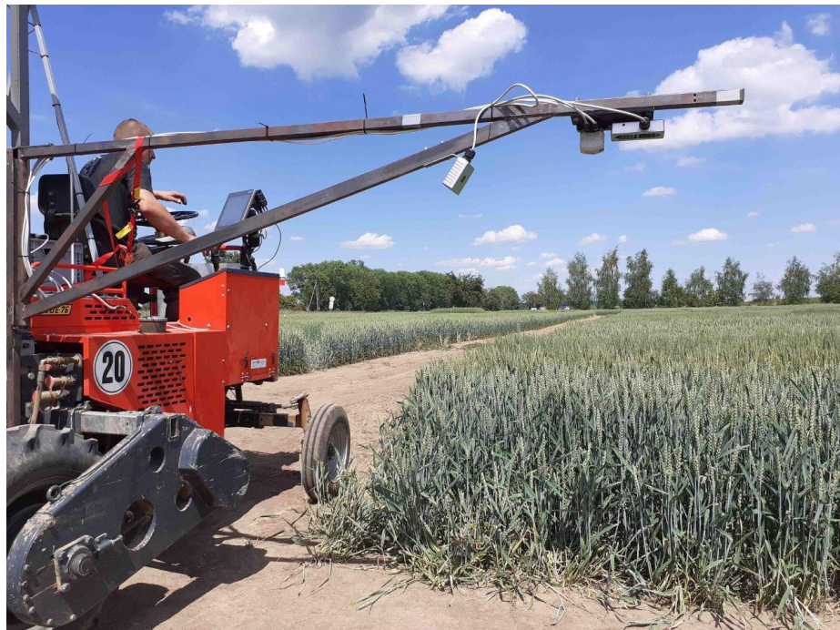
Obr. 10 Kamera připevněná k secímu stroji
