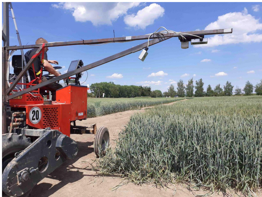
Obr. 10 Kamera připevněná k secímu stroji
