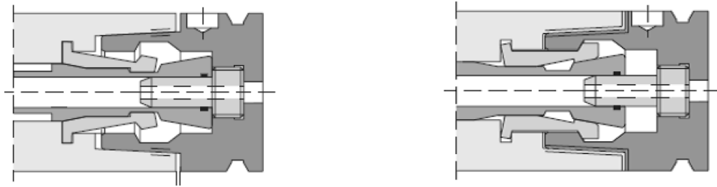
Obrázek 12 Upnutí HSK - stav před upnutím (nalevo), stav po upnutí (napravo)
