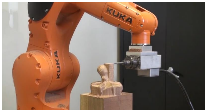
Obrázek 25 Frézování 3D modelu robotem
