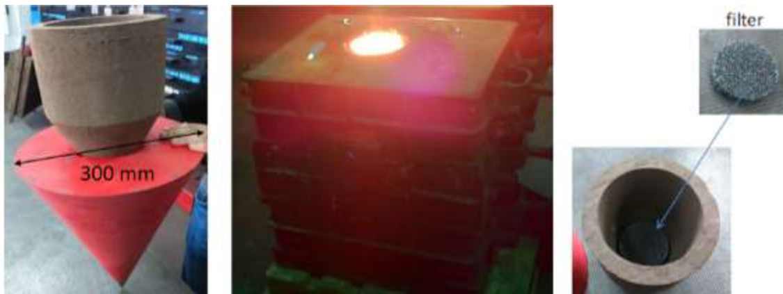
Obr. 23: Náhled zkušebních těles kuželů z Bauerova experimentu [35].
