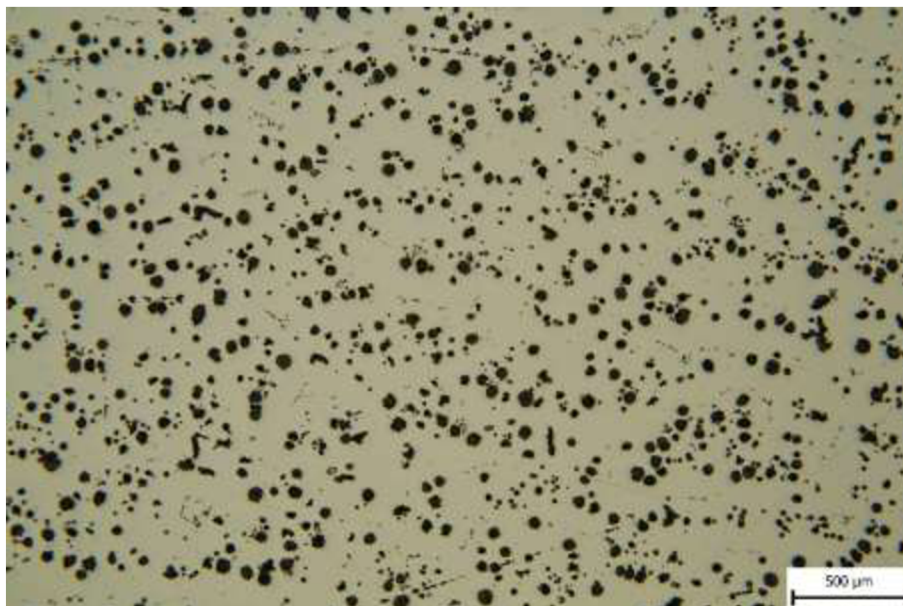
Obr. 67 Výbrus vzorku T2-Y100-M3 odpovídající zkušebním tělesům T2-Y100-M a T2-Y100-R. Původní zvětšení: 50x.
