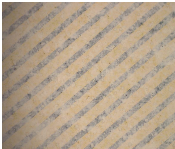
Obr. 19: Interdigitální struktura s nanesenou aktivní vrstvou SnO 2 .
