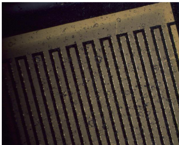
Obr. 37: Vzhled aktivní vrstvy grafenoxidu po modifikaci naprašováním Pt.
