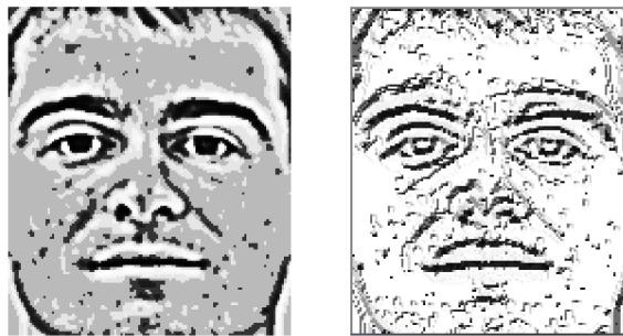
Obr. 24 Výpočet LBP (vstupní obraz vlevo, vypočtený LBP vpravo)
