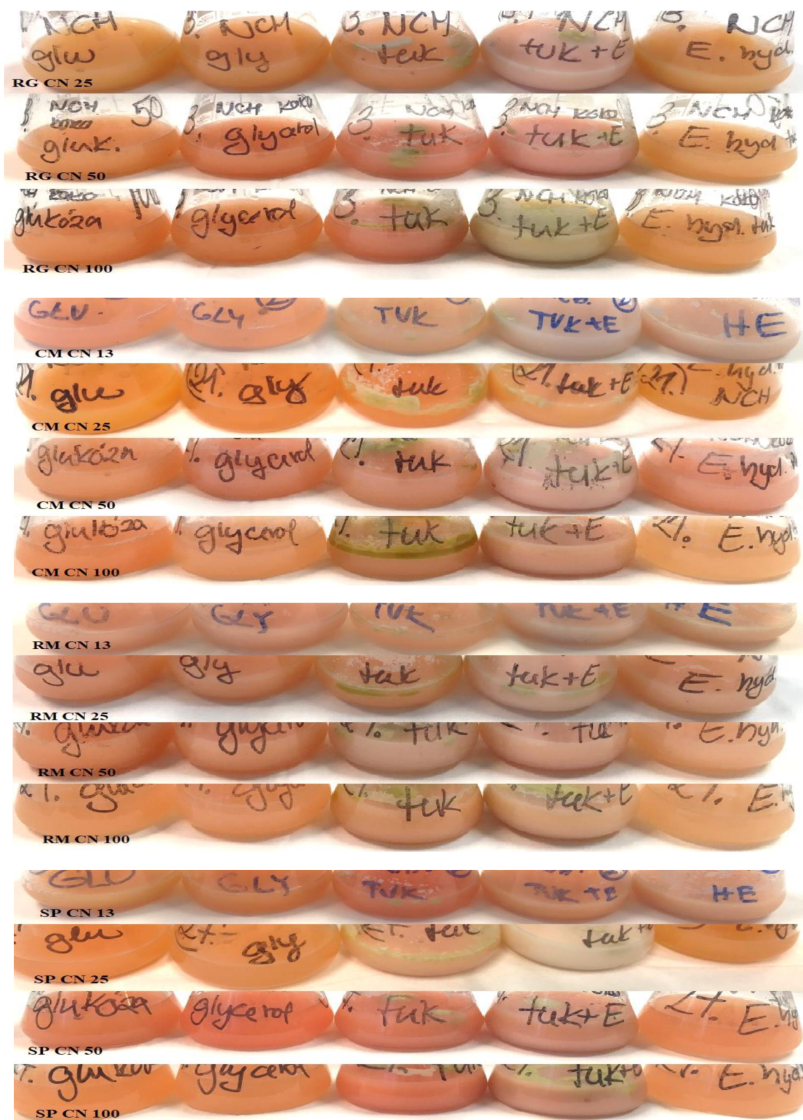
Obrázek 122 Základní kultivace kvasinek (médium - glukózové, glycerolové, tukové, tukové s emulgátorem, hydrolyzovaný tuk)
