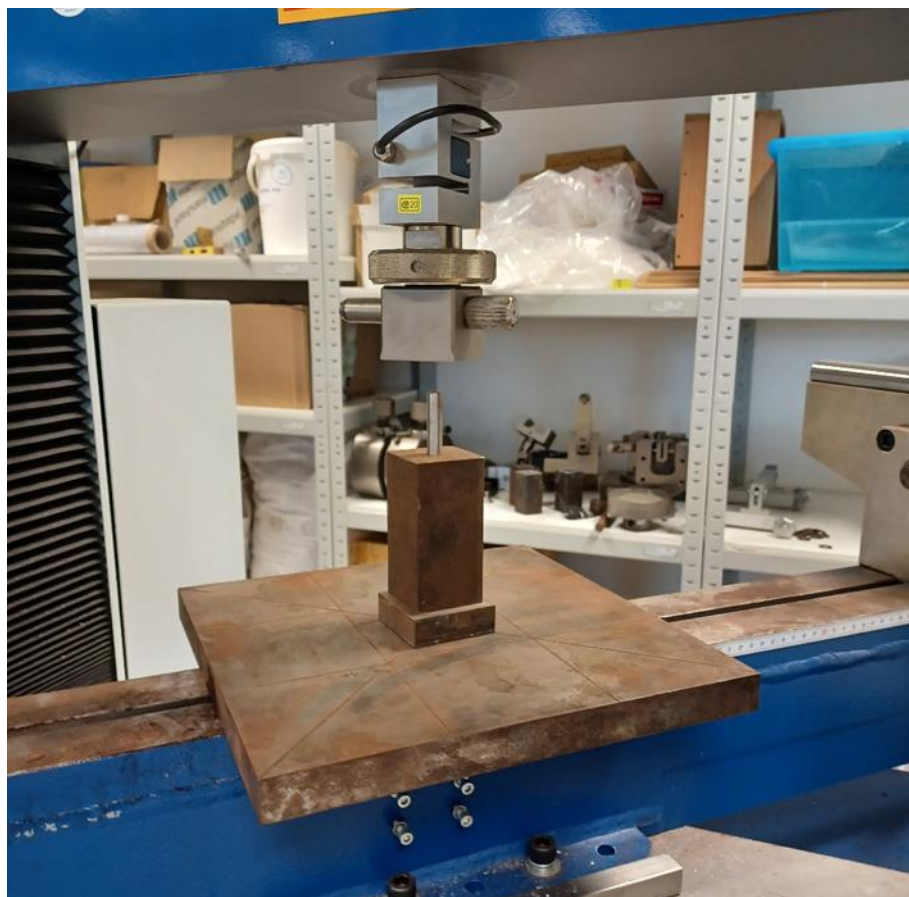
Obrázek 13 Peletovací sestava umístěná v lisu (vlastní zpracování)
