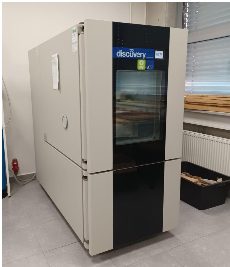
Obrázek 15 Klimatizační komora (vlastní zpracování)
