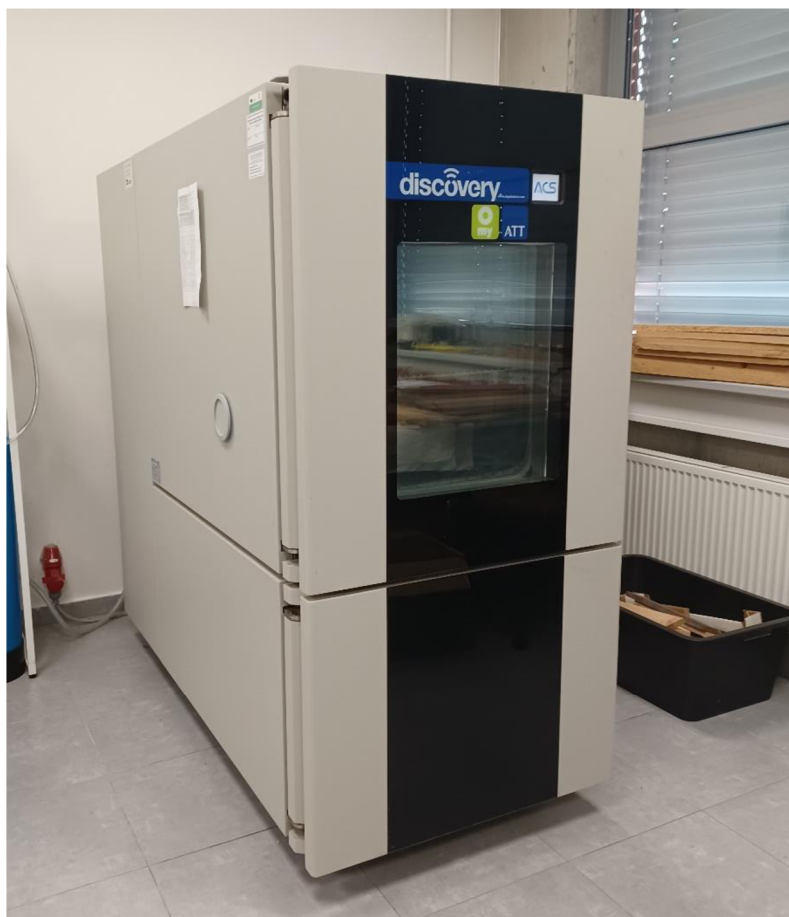
Obrázek 15 Klimatizační komora (vlastní zpracování)
