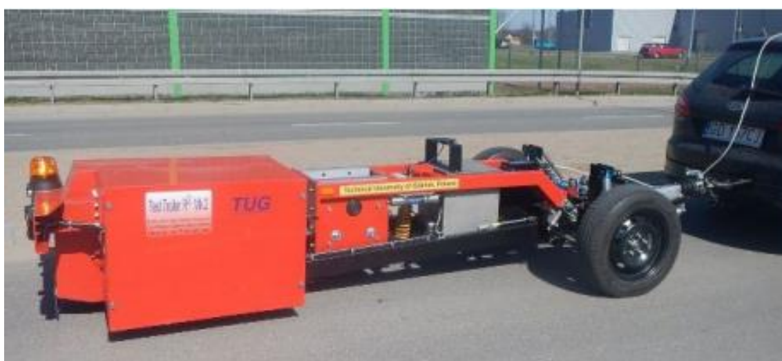
Obrázek 37 Schéma měřícího přívěsu s přidáním kompenzačním členem [59]
