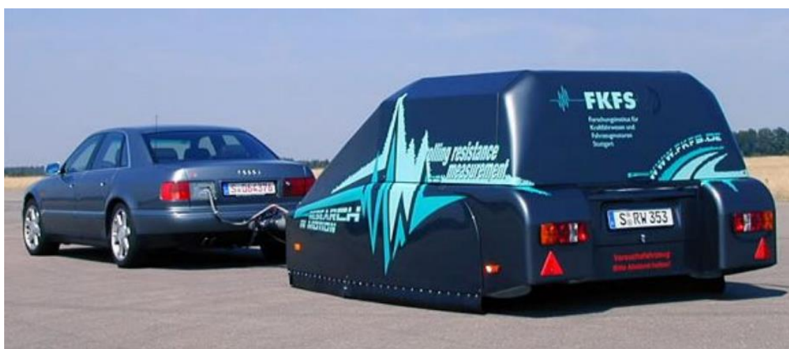
Obrázek 39 Měřící přívěs Forschungsinstitut für Kraftfahrwesen und Fahrzeugmotoren Stuttgart (FKFS) [60]
