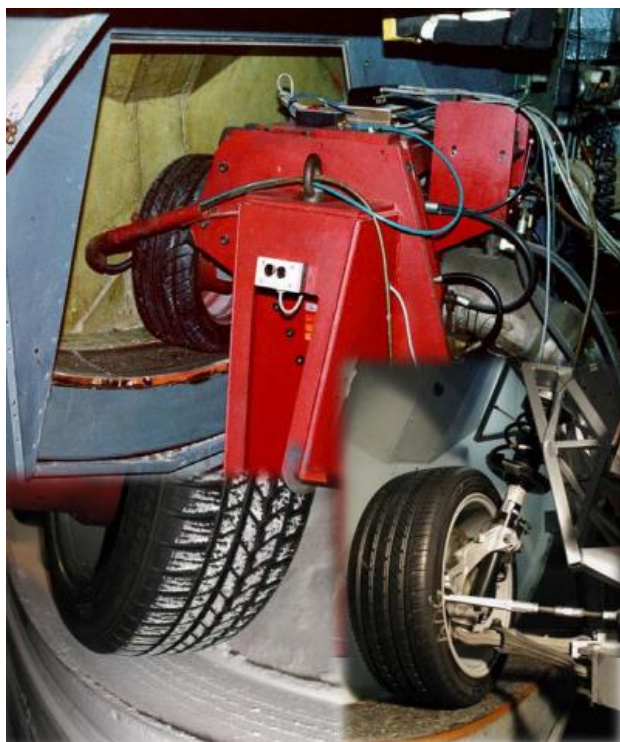
Obrázek 30 Měření probíhající na vnitřní straně bubnu [55]
