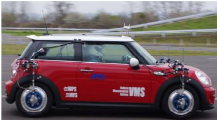
Obrázek 40 Měřicí vozidlo společnosti A&D [61]
