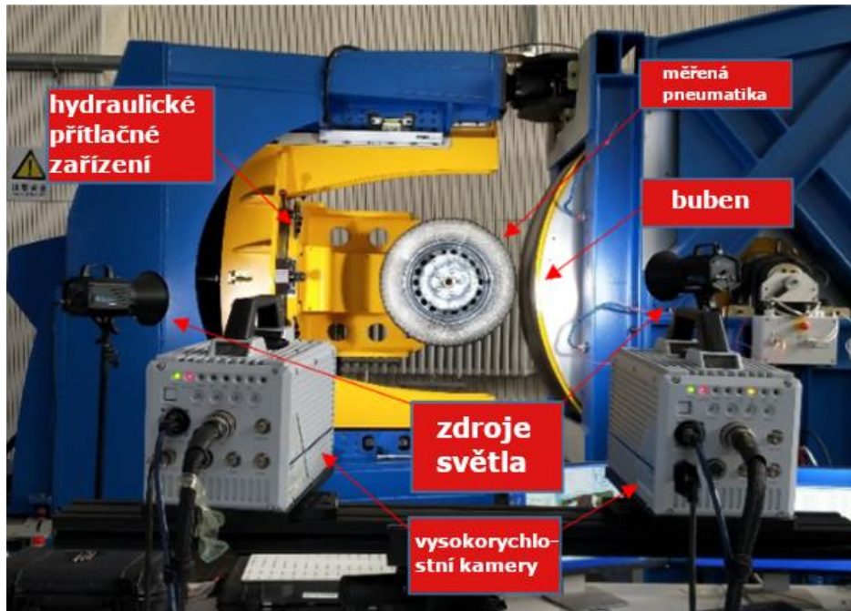
Obrázek 33 Bezkontaktní měření s využitím vysokorychlostních kamer [57] (upraveno)
