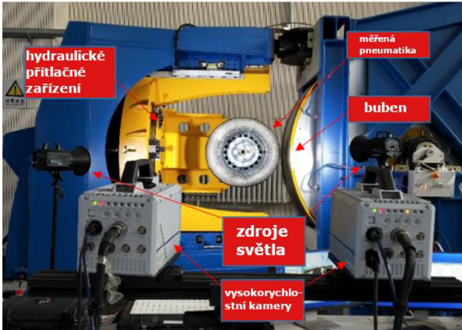
Obrázek 33 Bezkontaktní měření s využitím vysokorychlostních kamer [57] (upraveno)
