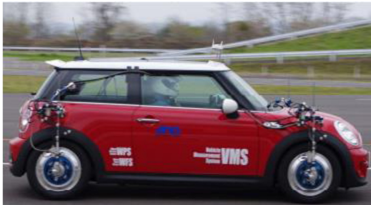
Obrázek 40 Měřicí vozidlo společnosti A&D [61]
