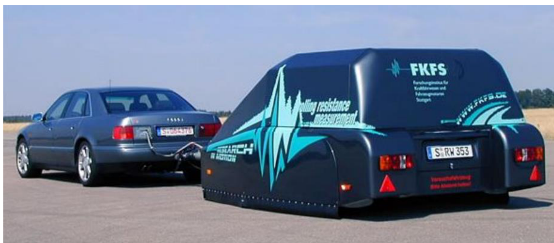
Obrázek 39 Měřicí přívěs Forschungsinstitut für Kraftfahrwesen und Fahrzeugmotoren Stuttgart (FKFS) [60]
