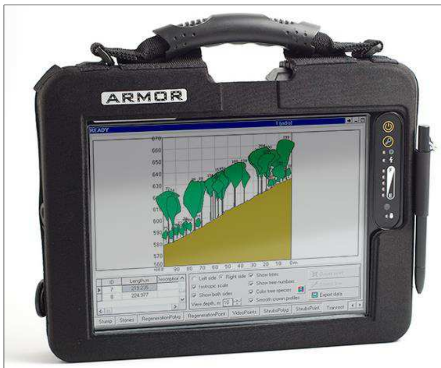
Obrázek č. 12: Hardwarové vybavení technologie Field-Map – jeden z možných typů terénního počítače
