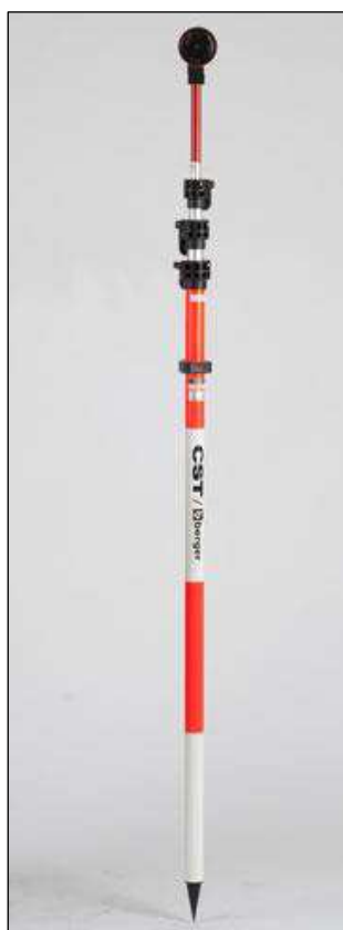
Obrázek č. 16: Hardwarové vybavení technologie Field-Map – teleskopická výtyčka s odrazkou
