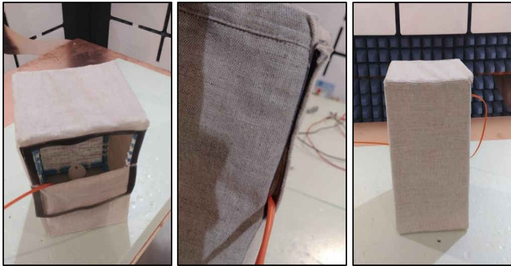
Obrázek 16 - První návlek bez nerez ocelových vláken
