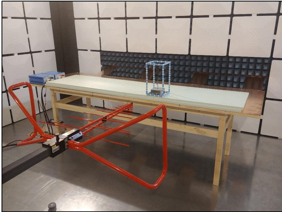
Obrázek 20 - Uspořádání testu při zkouškách EMI – horizontální polarizace antény
