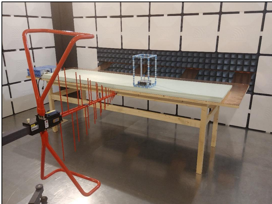
Obrázek 21 - Uspořádání testu při zkouškách EMI – vertikální polarizace antény
