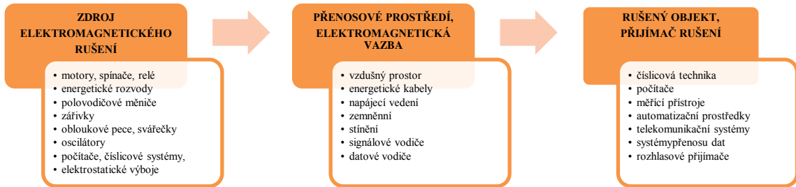
Obrázek 1 - Základní řetězec EMC a příklady jednotlivých oblastí
