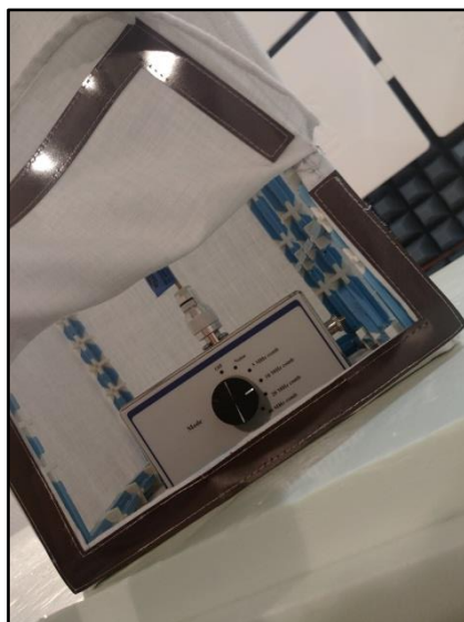
Obrázek 19 - Nastavení hřebenového generátoru
