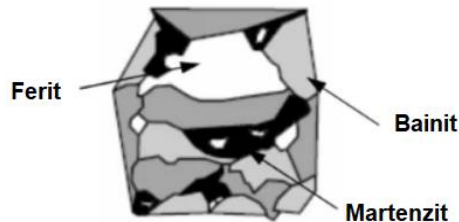
Obr. 10 Metalurgie CP oceli. [14]
