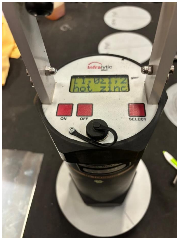
Obr. 51 Měření množství maziva pro požadovanou hodnotu 1 \text{ g/m}^2 .
