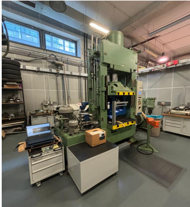
Obr. 54 Pohled na strojní zařízení pro zjišťování vlivu maziva na proces tažení.
