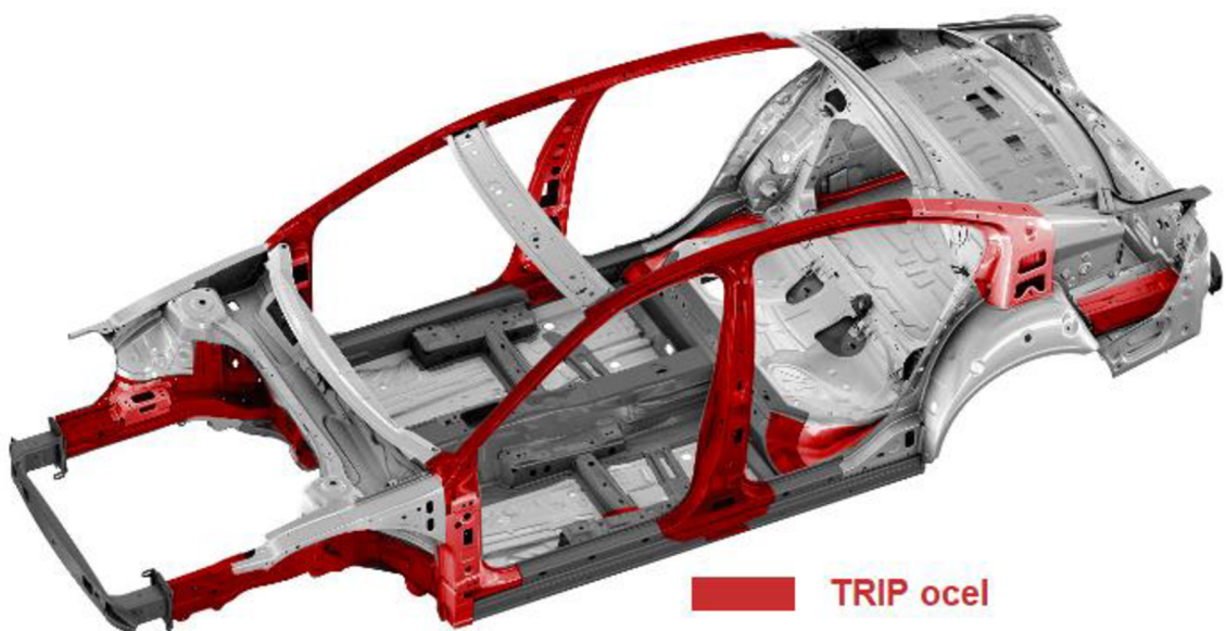
Obr. 9 Použití TRIP oceli v automobilu. [12]
