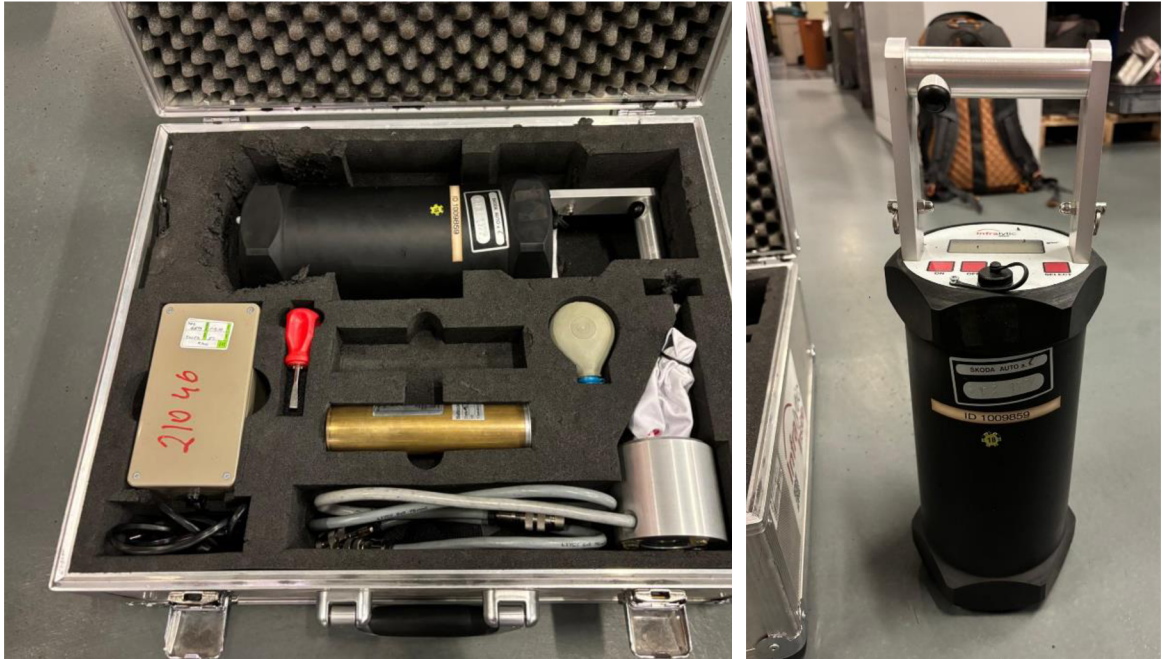
Obr. 50 Zařízení pro měření tloušťky vrstvy maziva na povrchu plechu.
