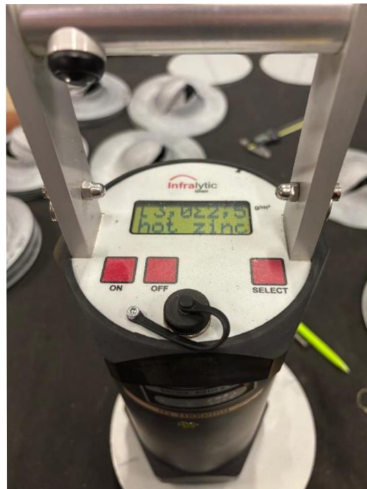
Obr. 53 Měření množství maziva pro požadovanou hodnotu 3 \text{ g/m}^2 .
