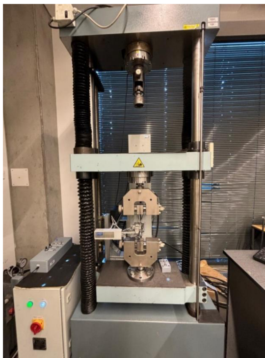
Obr. 41 Zařízení pro zkoušku tahem TIRA Test 2300.
