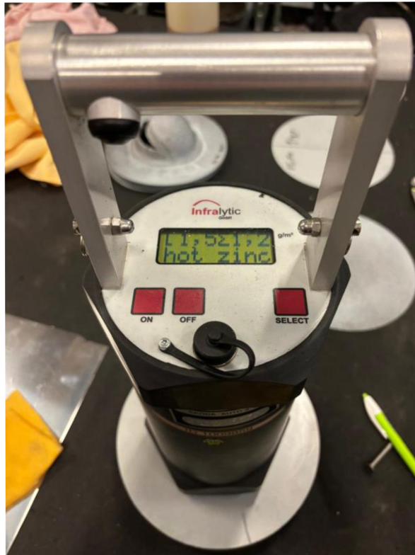
Obr. 52 Měření množství maziva pro požadovanou hodnotu 1,5 \text{ g/m}^2 .
