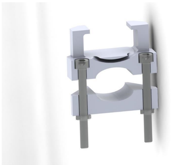
Obrázek 3.6 - Řez třetím modelem úchytu pro znázornění zahloubení
