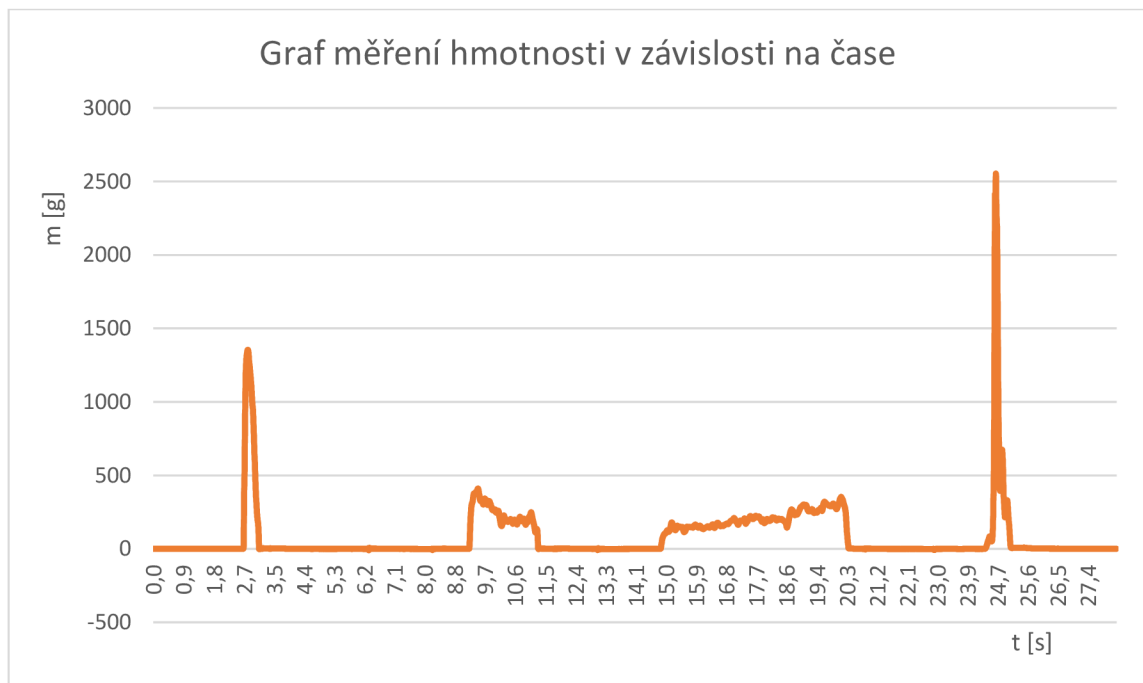
Obrázek 6.3 - Graf závislosti hmotnosti na době, po kterou je vyvíjen tlak na snímač
