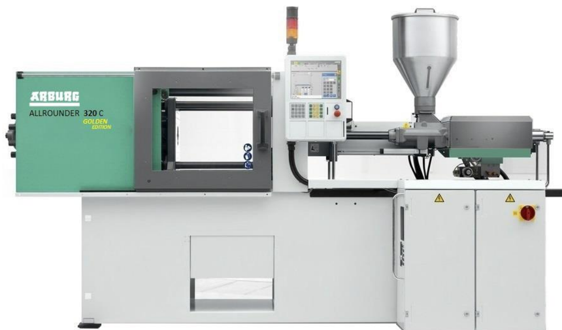
Obr. 3.16 Vstřikovací stroj Arburg Allrounder 320 C Golden Edition [52]
