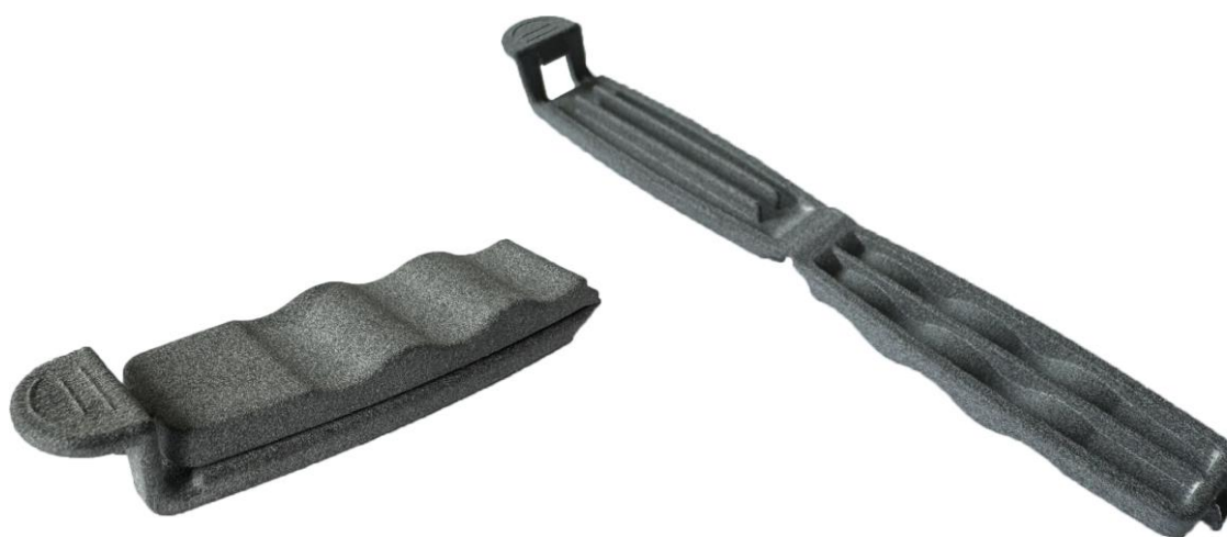
Obr. 3.15 Prototyp svorky zhotovený technologií fúzování prášku UV světlem
