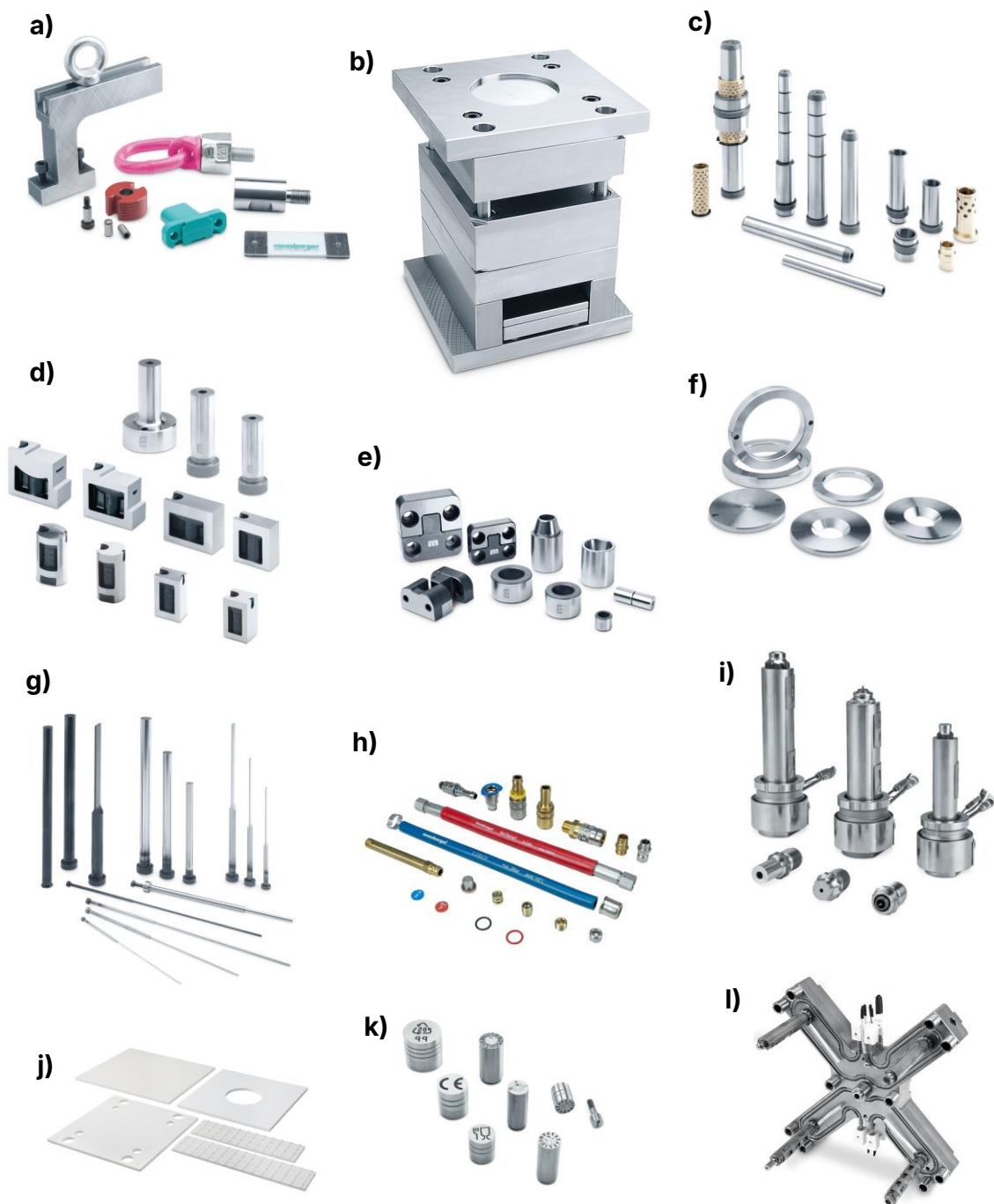
Obr. 2.24 Příklady normálií vstřikovacích forem: a) upínací prvky, b) rám formy, c) vodící prvky, d) vtokové prvky, e) středící prvky, f) středící kroužky, g) vyhazovací kolíky a jádra, h) prvky temperačního systému, i) horké vtokové trysky, j) izolační desky, k) datumové vložky, l) horký rozváděcí blok, upraveno dle [48, 50]
