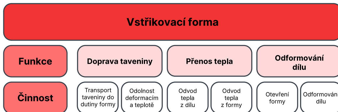
Obr. 2.5 Základní funkce vstřikovací formy, upraveno dle [16]
