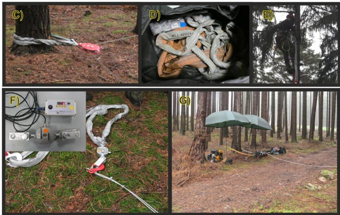
Obr. 6 Schéma průběhu tahové zkoušky (A); (B) Měřené veličiny v průběhu zkoušky ( h – výška stromu, h_c – těžiště koruny, \beta_0 - inklinace báze stromu, \beta_F - úhel napínání lana, F_h a F_v - horizontální a vertikální složky napínací síly F ); (C) detail směrové kladky; (D) úvazky; (E) umístění úvazku v koruně pomocí lezecké soupravy; (F) tenzometr; (G) Stromotrh
