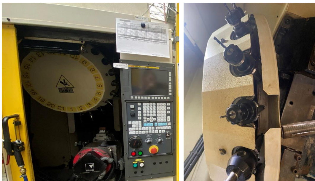
Obr. 51) a) Pohled na rotační zásobník CNC stroje b) Výchozí pozice ručního vkládání nástrojů
