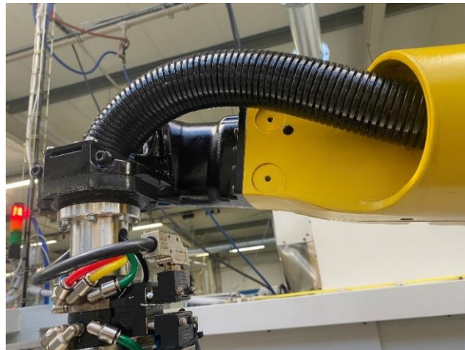
Obr. 15) a) Detail uložení konzole b) Detail uložení kabeláže skrz 4. osu
