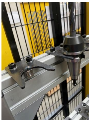
Obr. 73) Uchycení nástroje a pozice odběru
