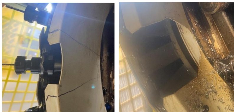
Obr. 70) Rozšíření otvoru v zásobníku CNC 1
