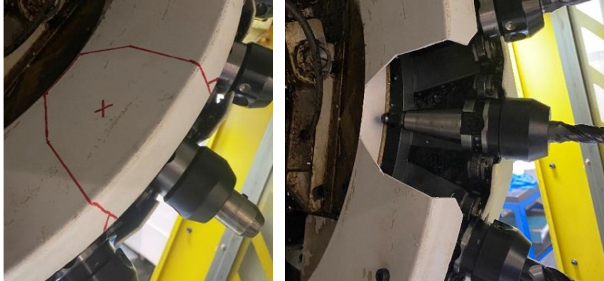
Obr. 71) Vytvoření nového otvoru v zásobníku CNC 2
