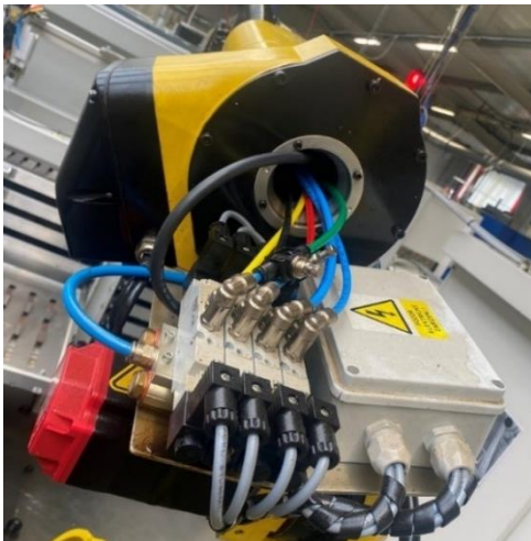
Obr. 15) a) Detail uložení konzole b) Detail uložení kabeláže skrz 4. osu
