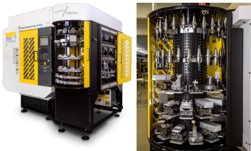
Obr. 8) a) Fanuc Robodrill s buňkou Häberle RobodrillPlus-K Max b) Detail na uložení nástrojů v karuselu [23]
