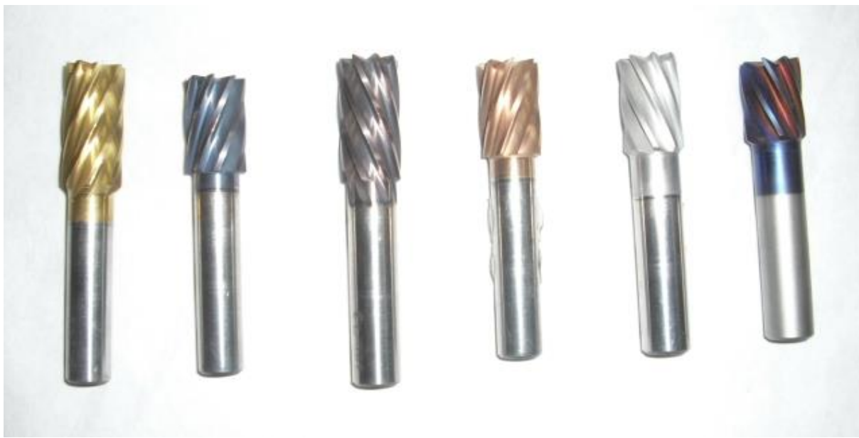
Obrázek 2: Aplikace technologie tenkých vrstev v praxi (vrtáky). Převzato z [5]
