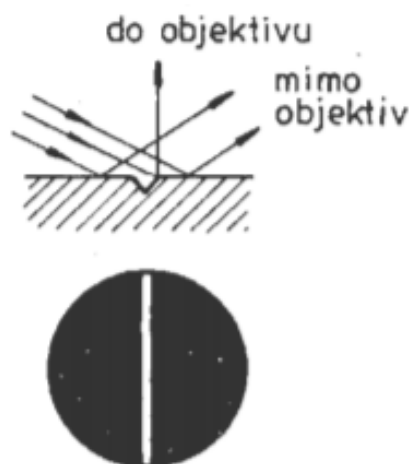
Obrázek 11: Schéma šikmého osvětlení vzorku. Převzato z [19].
