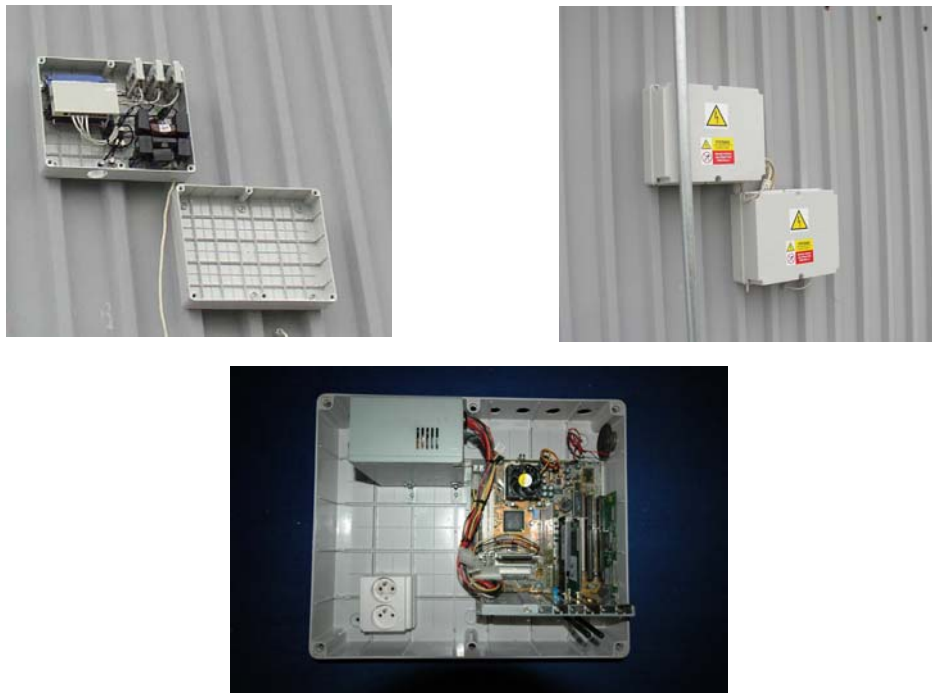
Obrázek 8 - použité montážní krabice GEWISS-GW44210 na vysílači Bobr1
