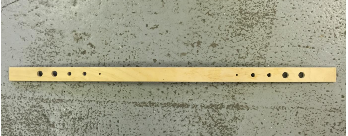
Obr. 27 Březová lamela s vyfrézovanými kulatými otvory
