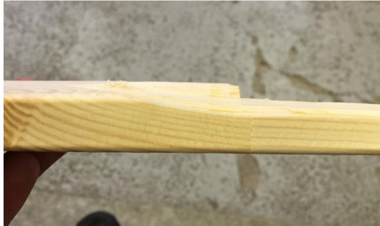
Obr. 49 Ukázka odklonu vláken
