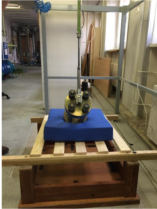
Obr. 40 Ukázka zatížení na stroji pro rázovou zkoušku se zatěžovacím kladivem
