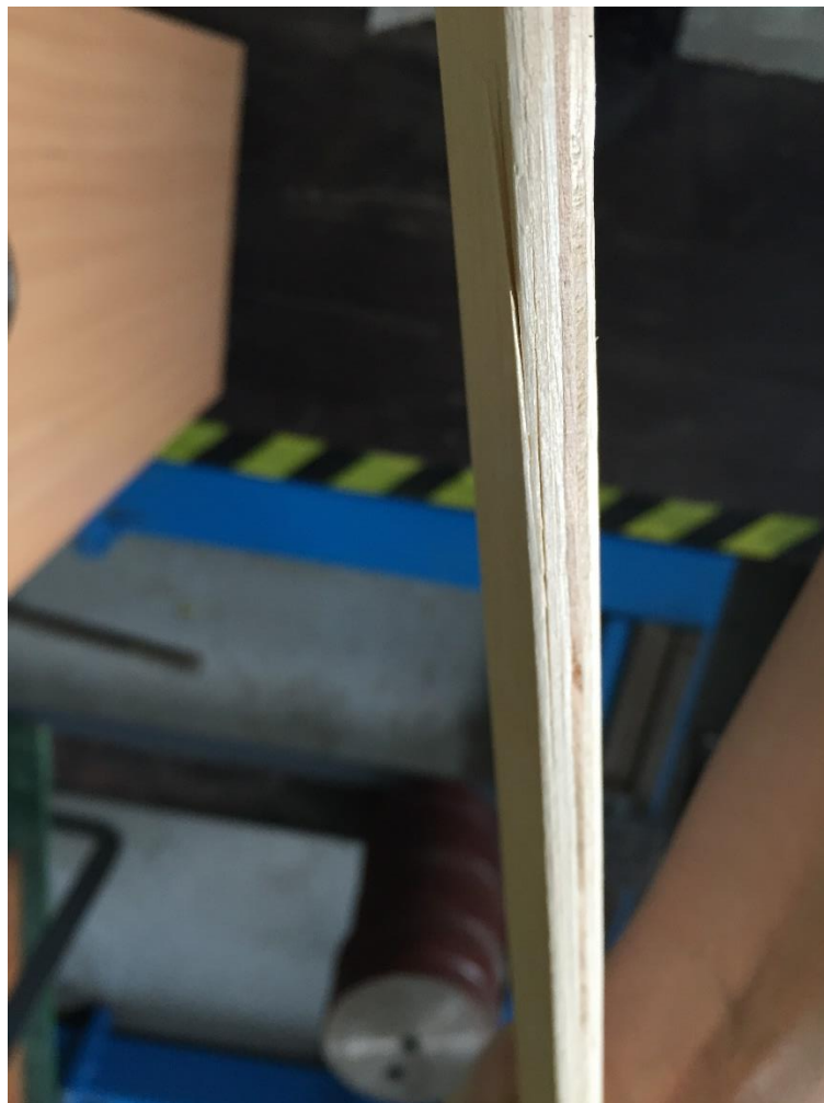
Obr. 53 Detail vad vnitřních vad u vzorku č. 5
