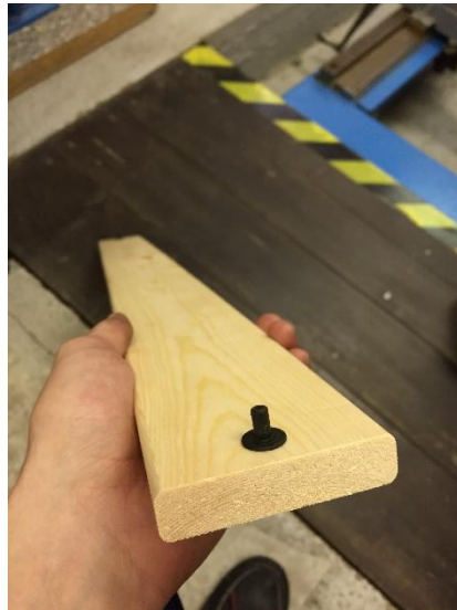
Obr. 10 Detail upínacího elementu
