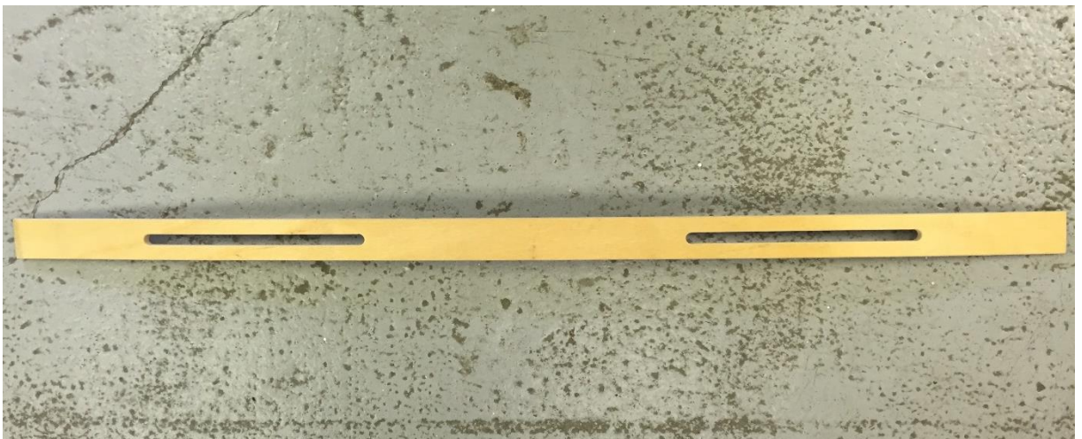
Obr. 28 Březová lamela s vyfrézovanými podlouhlými otvory
