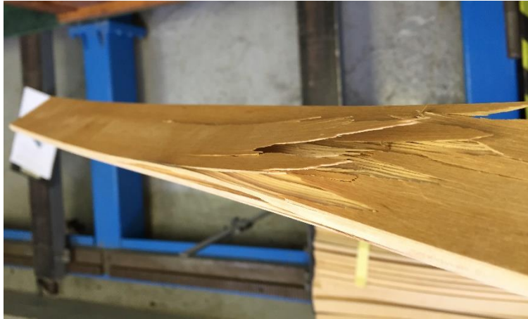
Obr. 51 Detail vady vnitřních dých lamely
