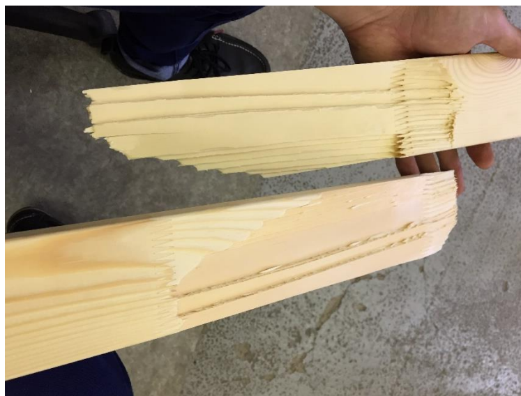
Obr. 50 Výsledek odklonu vláken
