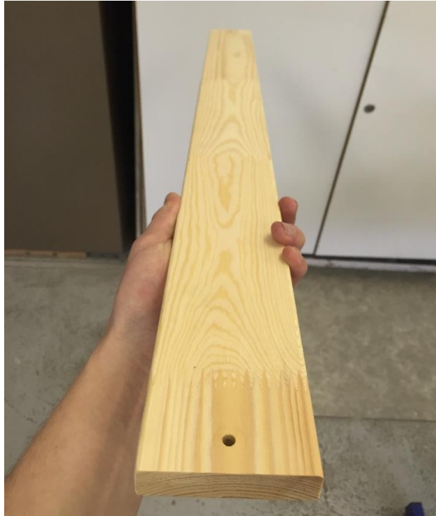
Obr. 23 Borovicová lať spojena na miniozub
