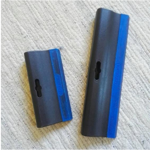
Obrázek 18: Stěrky k roznesení barvy po celé ploše síta
