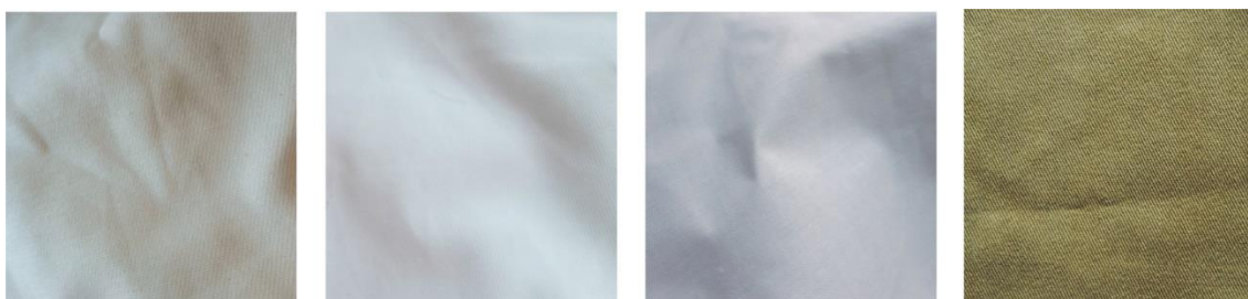
Obrázek 11: Použité textilní materiály: bavlněný smetanový kepr, bavlněný bílý kepr, bílé bavlněné plátno, kepr obarvený zlatou barvou
