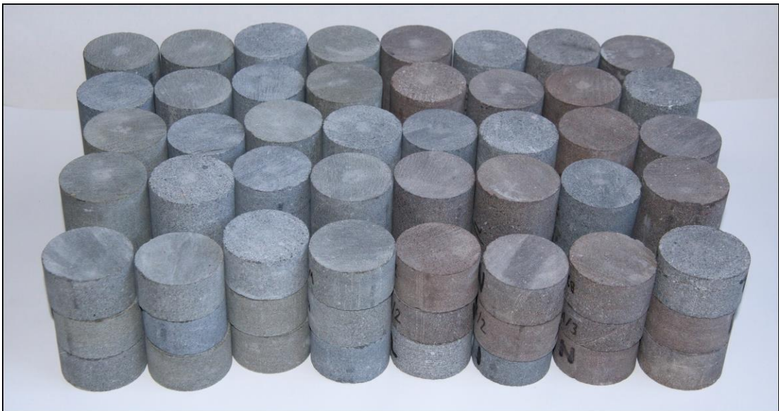
Obr. 5-1: Sada těles vyrobená z jemnozrnné droby
