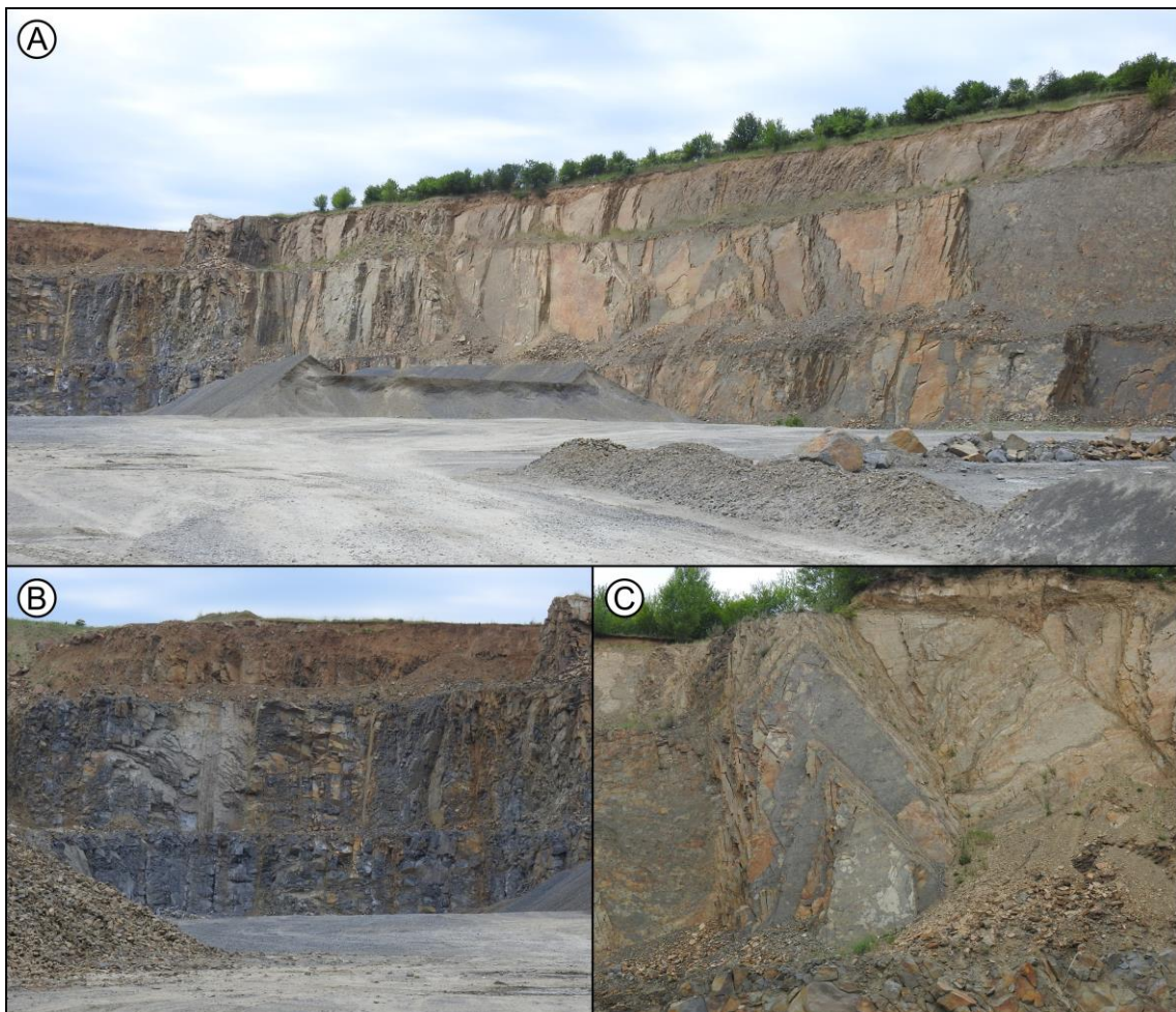
Obr. 4-2: Lom Koberřice: A – pohled na jihozápadní stěnu, B – pohled na jižní stěnu, ukazující blokovou odlučnost horniny, C – pohled na západní stěnu, kde je znatelné zvrásnění místního masivu
