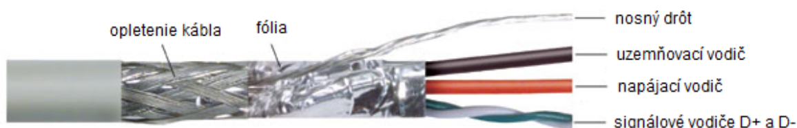
Obrázok č. 2: Štruktúra kábla USB
