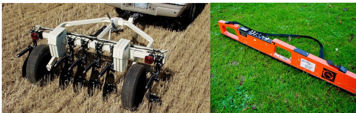
Obr. 3.5 Invazivní elektrodový senzor Veris-3100 (vlevo) a Neinvazivní senzor pro měření elektromagnetické indukce Geonics EM-38 (zdroj: Lukáš, Neudert a Křen, 2011)
